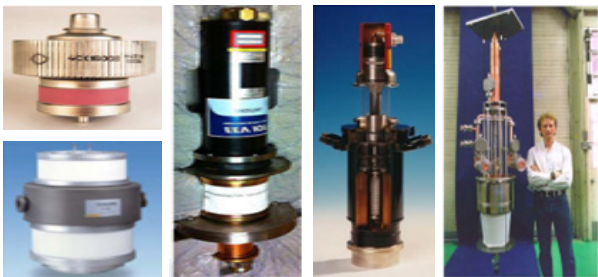
شکل ۲: چند نمونه از لامپ‌های میکروویو. از راست به چپ به ترتیب کلاسترون، مگنترون، IOT و تترود [۲].
