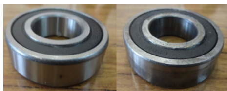
شکل ۶. یاتاقان موتور القایی قبل و بعد از معیوب شدن [۸]
