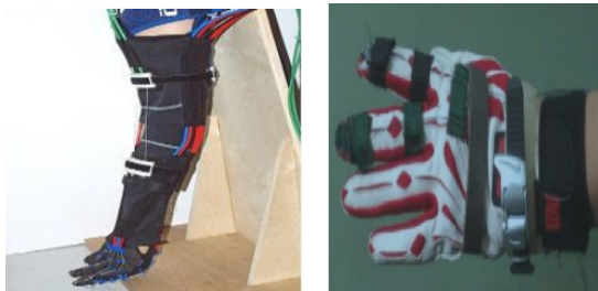
الف شکل ۵_الف: دستکش SNU Exo [۵] ب شکل ۵_ب: دستکش حرکتی تاندون [۵]
