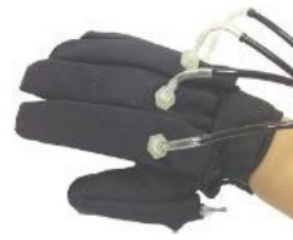
شکل ۷_الف: دستکش رباتیک نرم [۵]
