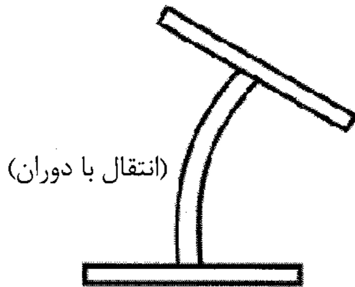
(ب) حالتی که بال فشاری در مقابل دوران زاویه‌ای نگهداری نشده است (مقطع A-A).
